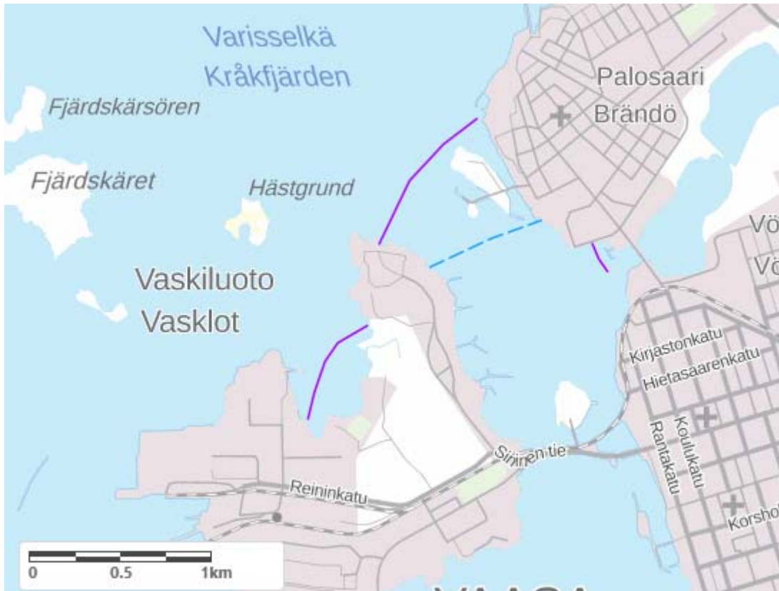
Kuva 17. Putket ja johdot tarkastelualueen läheisyydessä (violetti viiva = vesijohto, vaaleansininen katkoviiva = tuntematon johto) (Velmu -karttapalvelu 18.3.2019).
