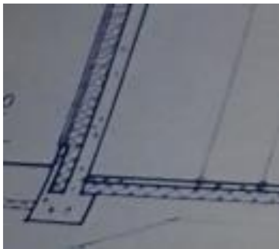
Kuva 15. Ulkoseinän rakennetyyppi alkuperäisten suunnitelmien mukaan, lomalaudoitus, pääty.
