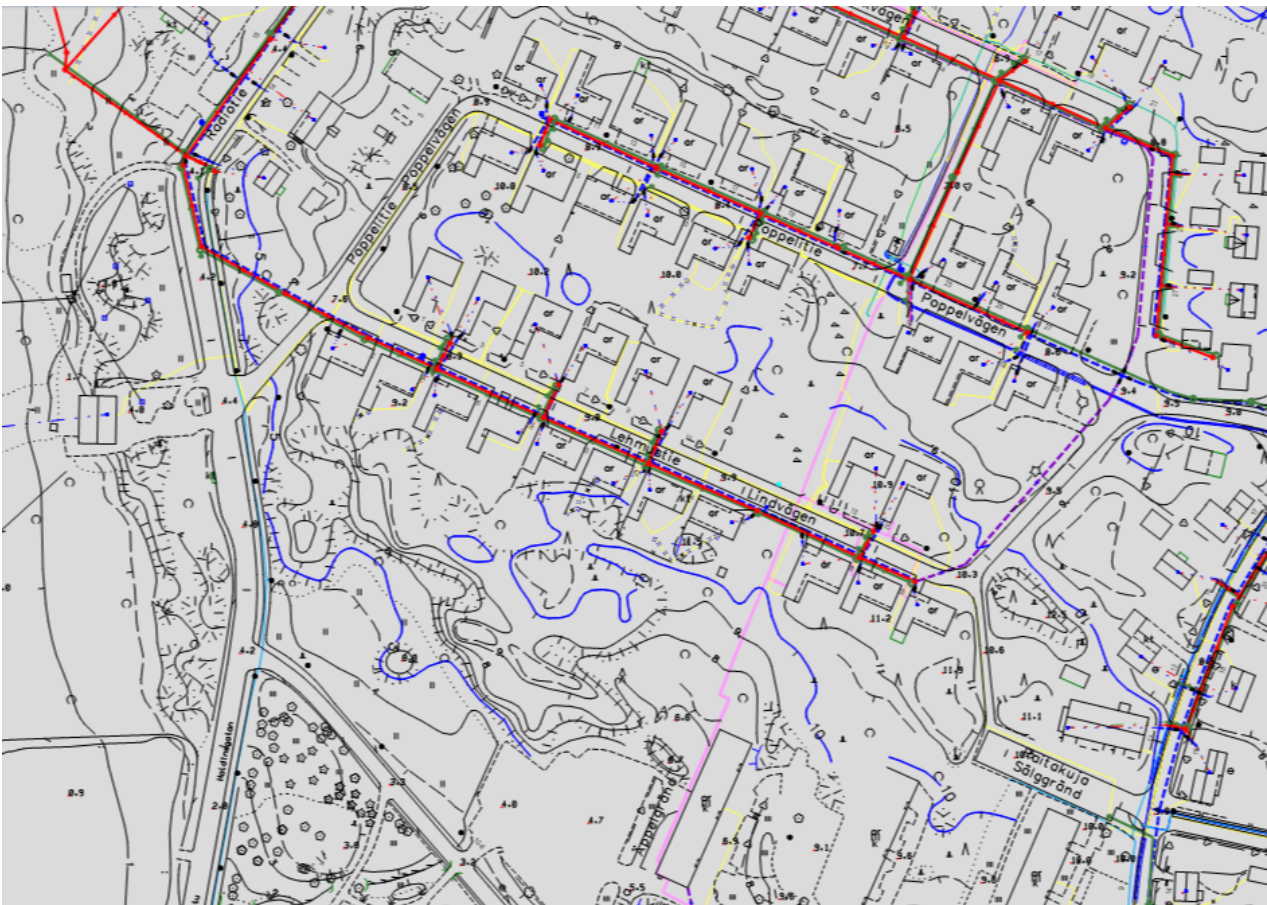
Utdrag över områdets el- och vattenledningsnät
