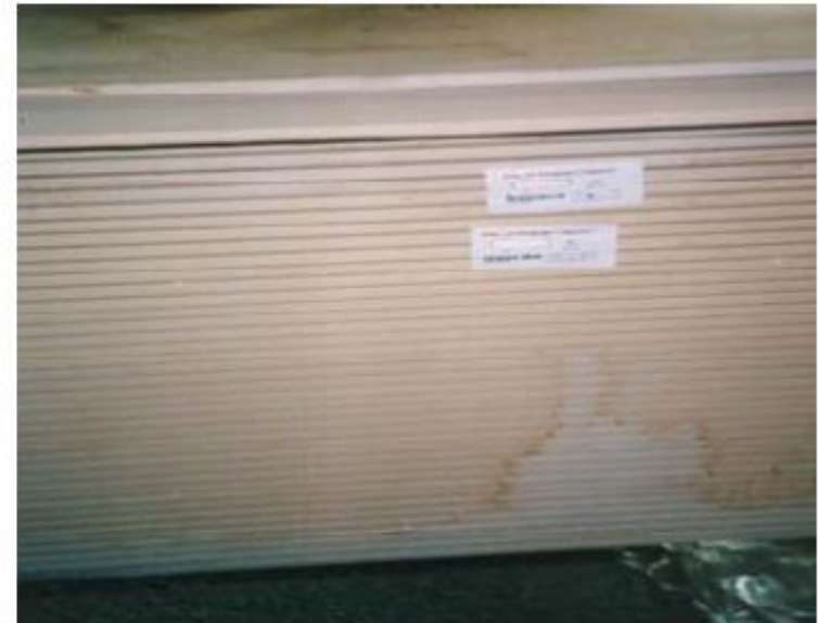
Bild 1 Mögelfläckar på papp (kartongen) Bild 2 Rinningsmärken på skivorna
