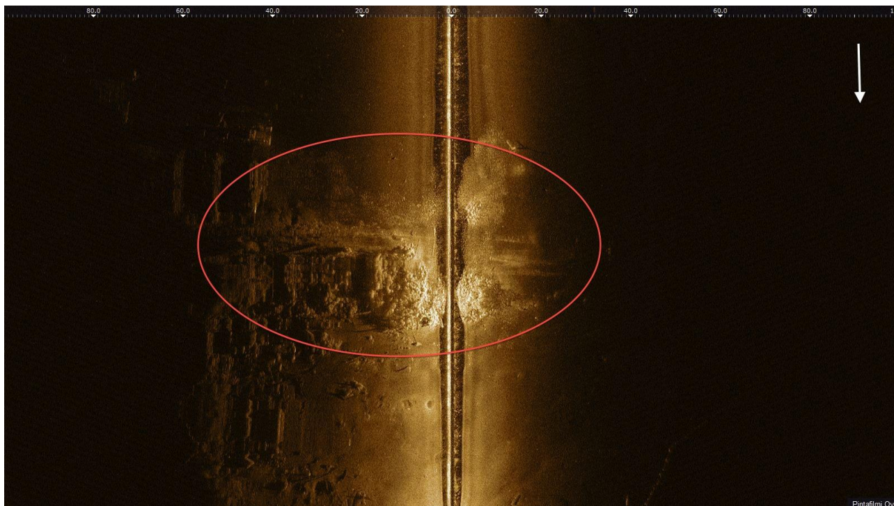
Kuva 18. Viistokaikuluotauskuva kohteesta 5. Telakanraiteet numero 3 raiteiden 1 ja 2 eteläpuolella.
