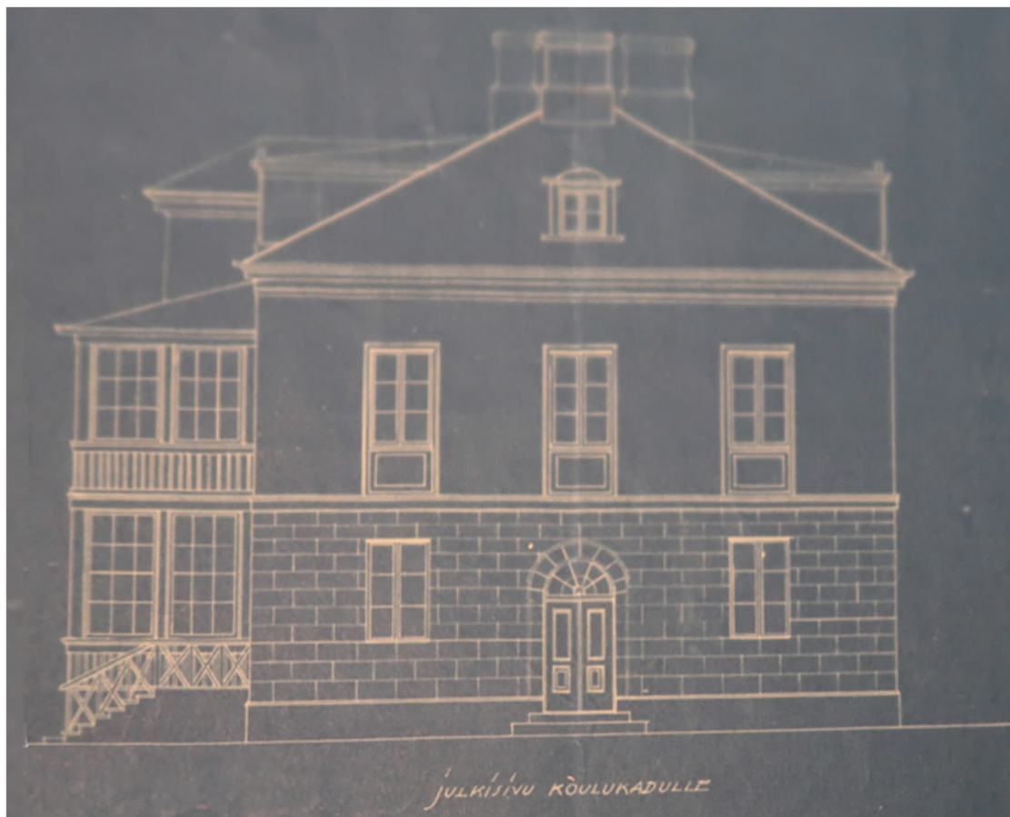
Kuva 57. Julkisivupiirros Koulukadulle vuodelta 1924 (toisessa rakennuslupavaiheessa). Piirroksessa näkyy myöhemmin poistettu lasiveranta sekä sisäänkäynti Koulukadulle. Piirroksessa on allekirjoituksena "Björklund & Myntti" (vinosti otetun valokuvan perspektiivi on suoristettu vastaamaan todellista asiakirjaa).
