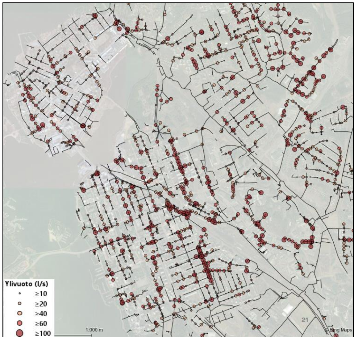
Kuva 7. Hulevesiverkoston ylivuodot kerran sadassa vuodessa toistuvalla 30 minuutin sateella (Kuva Fluidit Oy 4 ).
