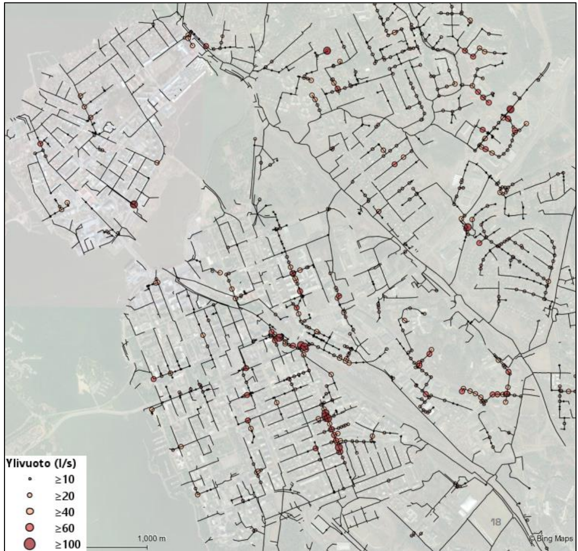
Kuva 6. Hulevesiverkoston ylivuodot kerran sadassa vuodessa toistuvalla 120 minuutin sateella (Kuva Fluidit Oy 4 ).
