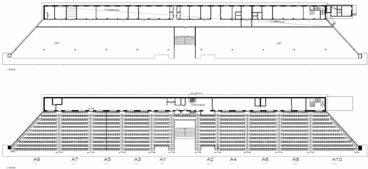
Kuva 11. Vanhan katsomon muutospiirustukset vuodelta 2015. 1. ja 2. kerroksen pohjapiirros. SIGGE Arkkitehdit.
