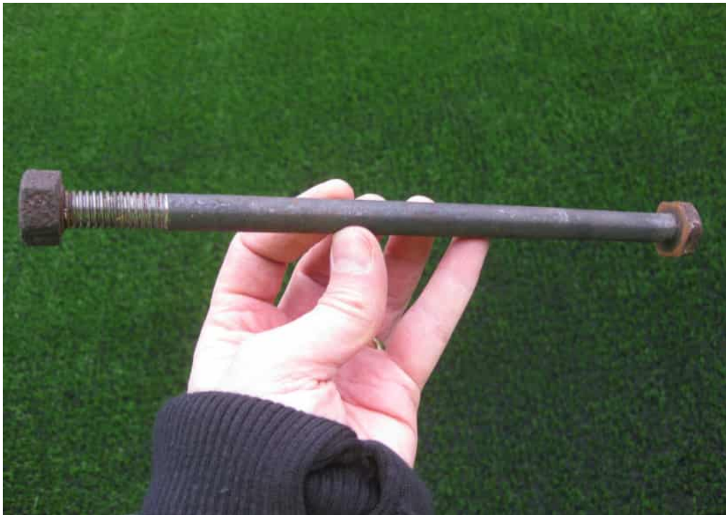
Kuva 10. Sekundääriristikon irrotetut pultit olivat hyvässä kunnossa pientä pintaruostetta lukuunottamatta.
