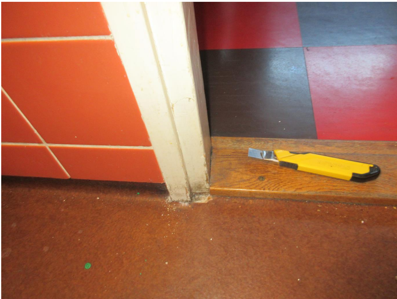
Kuva 10 5.9.2022 Sos.tila ent.ravintola Messi:Näyte 2 otettiin lattiamatoista 2 kpl ja liiman, näyte ei sisällä asbestia
