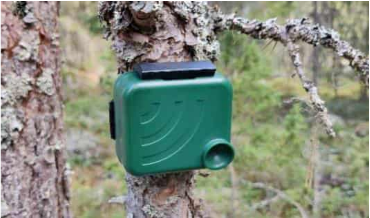
Kuva 4. AudioMoth on ohjelmoitava sisäisellä mikrofonilla varustettu ultraäänitallennin.
