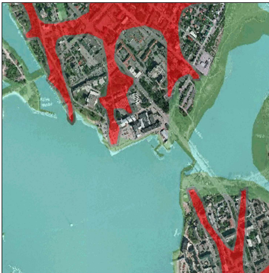
Bild 12. Landskapsstruktur: vattendelare (röda områden) och dalar (områden märkta med grönt) inklippta i flygfotot. Utrymme mellan grönt och rött tål bäst byggande enligt de utredningar som gäller landskapsstrukturen.
