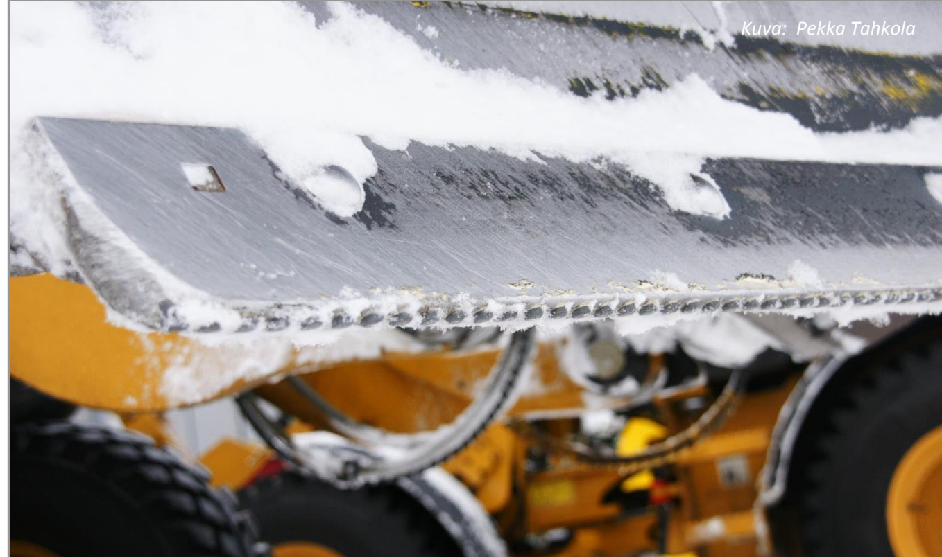
Kuva 11. Oulussa käytetty tiheä kovametallihammasterä takaa hyvän pinnan pyöräilylle talvella (Pekka Tahkola)
