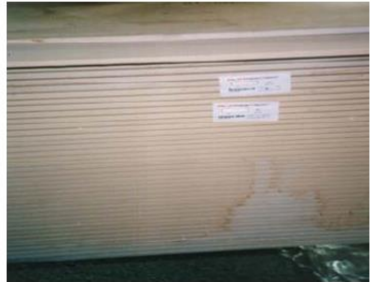
Bild 1 Mögelfläckar på pappen (kartongen) Bild 2 Rinningsmärken på skivorna
