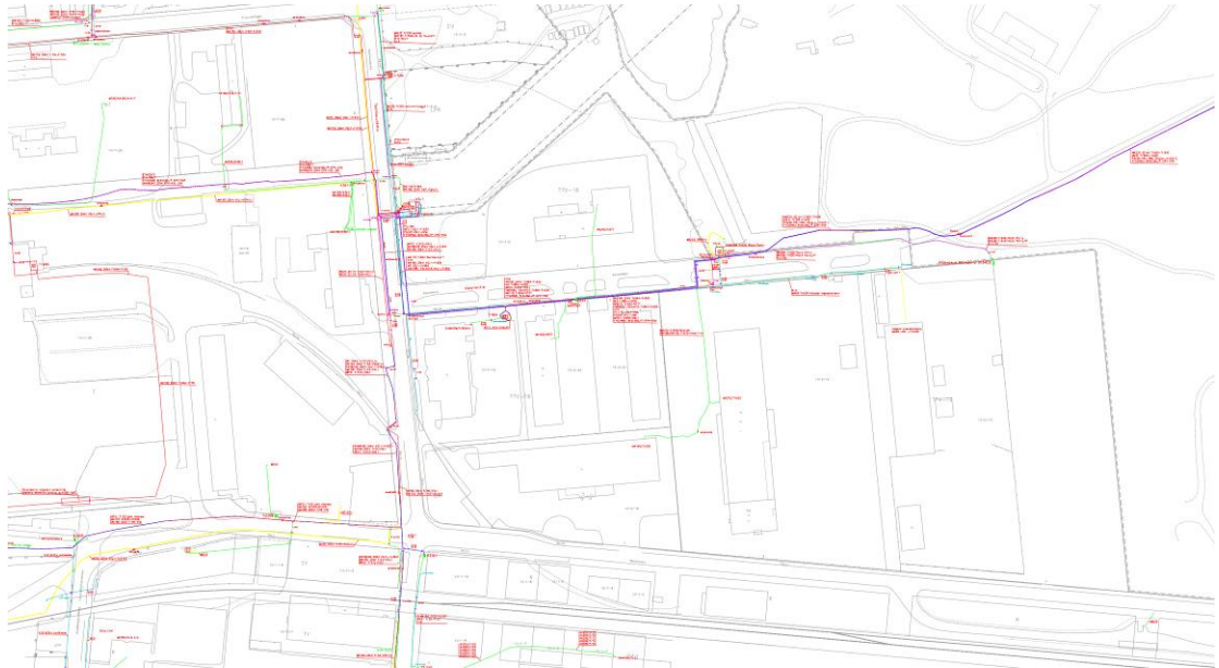
Vasa Vattens stamavloppslinje och stamvattenledningar
