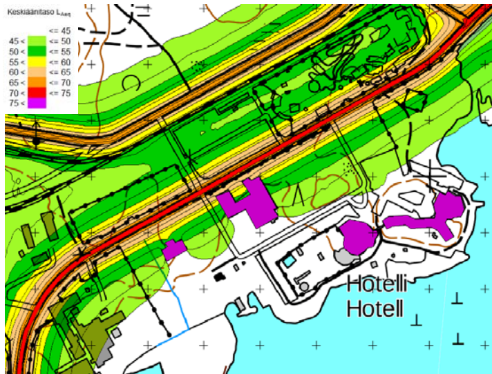
Kuva 18. Päiväajan keskiäänitasoalueet 2018 L_{Aeq7-22} , putkimallitarkastelu
