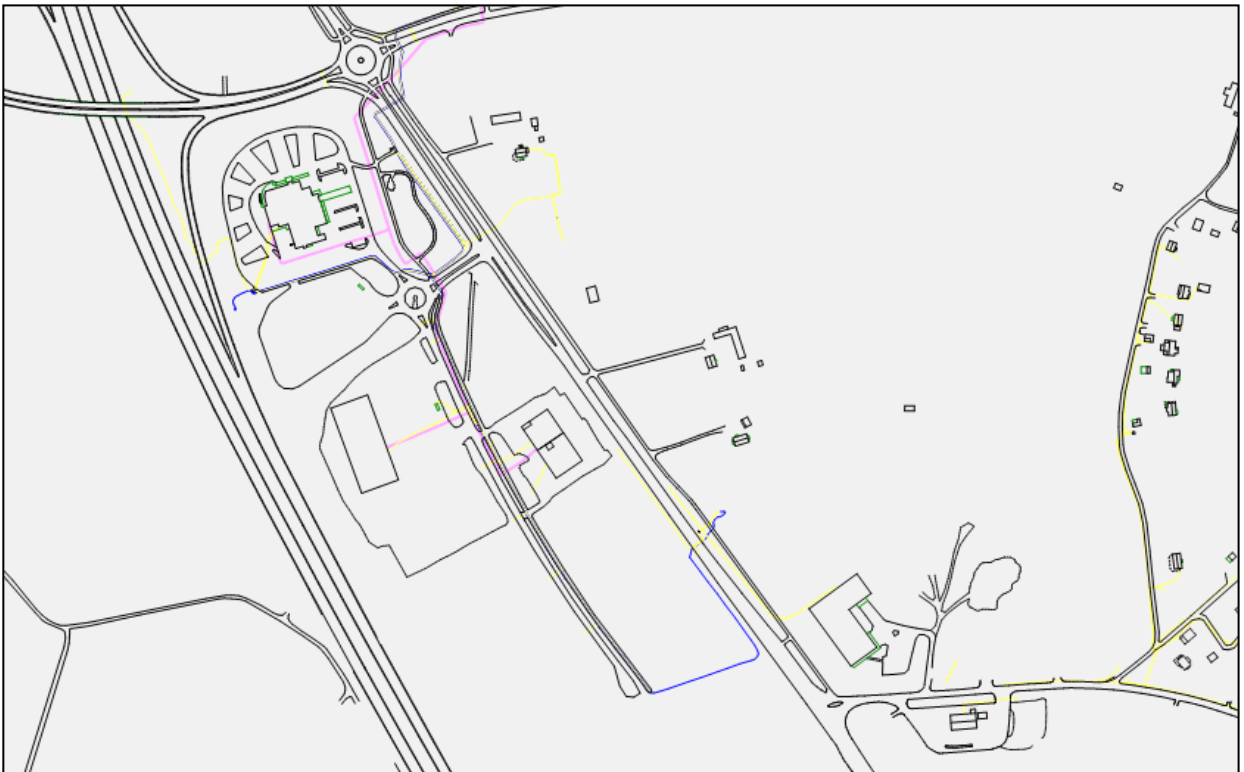
Kuva 22. Pien- ja keskijännitekaapelit (keltainen ja sininen) ja kaukolämpö (vaaleanpunainen).
