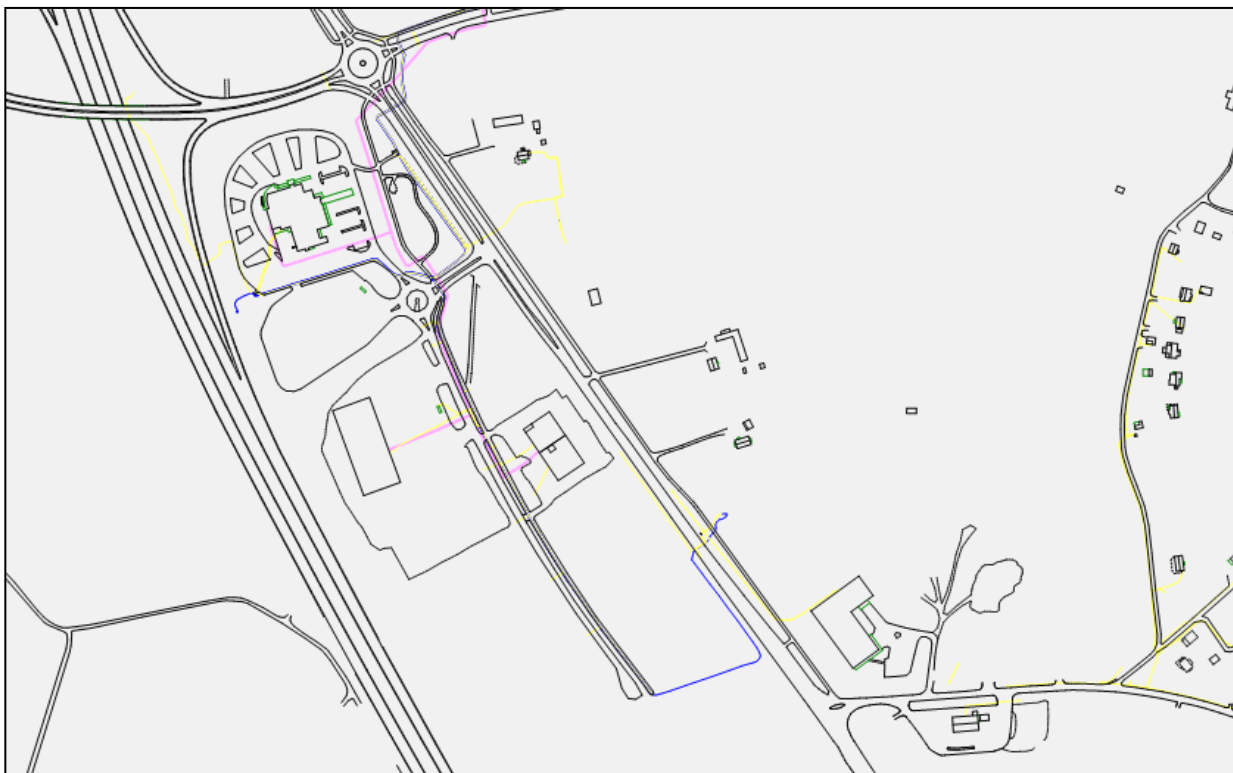
Bild 22. Låg- och mellanspänningskablar (gul och blå) och fjärrvärme (ljusröd)
