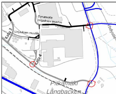
Kuva 13. Moduulilaverin ajouratarkastelut tehtiin uudella reitillä kolmessa katuliittymässä.
