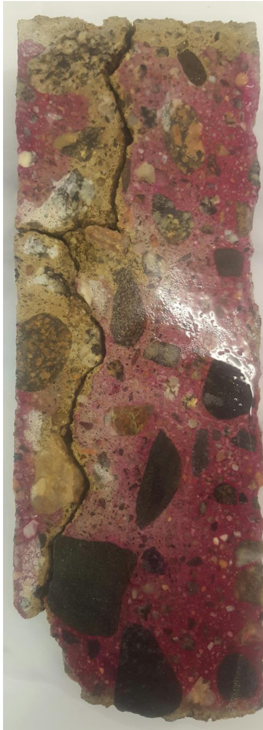
Kuva 1. Näyte N9. Savupiippunäytteen lävistää pintaa vasten kohtisuora halkeama.
