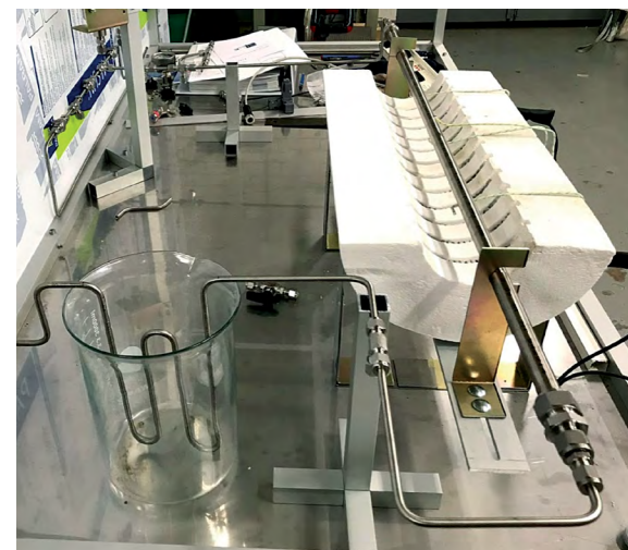
Täysin integroitu modulaarinen järjestelmä, jolla voidaan testata erilaisia synteetikaasun tuotantoprosesseja.
