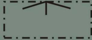
Rakennusala. Nuoli osoittaa rakennusalan sivun, johon rakennuksen ulkoseinä tai ulkoseinän osa on rakennettava kiinni.
