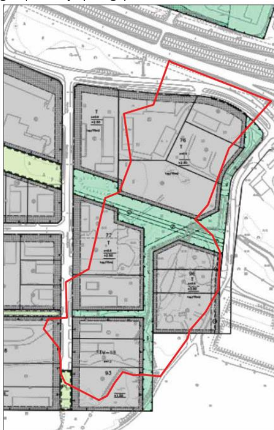
Bild 15 Avgränsning av området för avfallsfyllnaden markerat med röd linje (slutrapport över provsneringen, Vahanen 2016)
