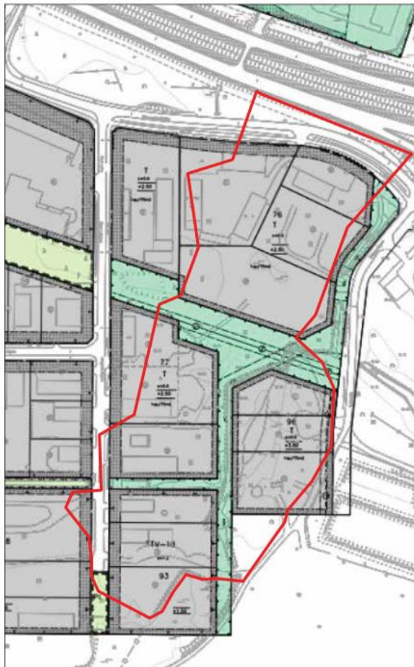
Kuva 15 Jätetäytön aluerajaus punaisella viivalla (Koekunnostuksen loppuraportti, Vahanen 2016)
