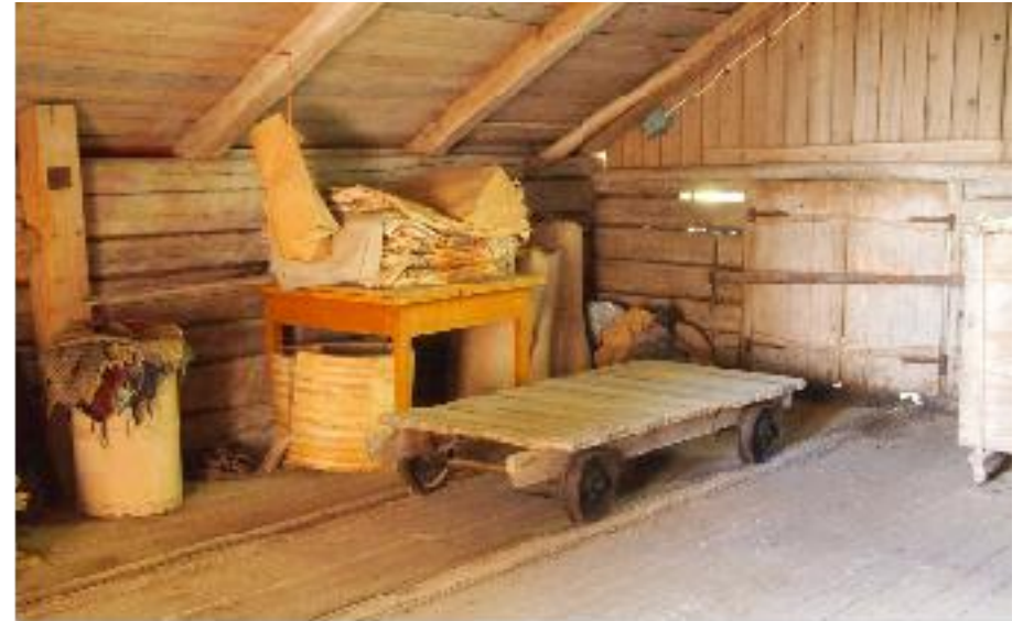
Säkinkuljetin kulki kiskoja pitkin myllysillalta jyvälaareille saakka.
