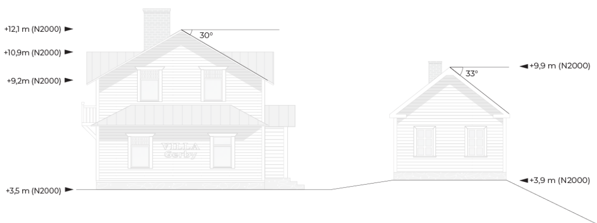
Bild 45. Massadisposition och förhöjningar i befintliga byggnader.
