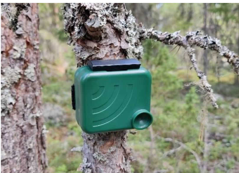
Kuva 5. AudioMoth on ohjelmoitava sisäisellä mikrofonilla varustettu ultraäänitallennin.
