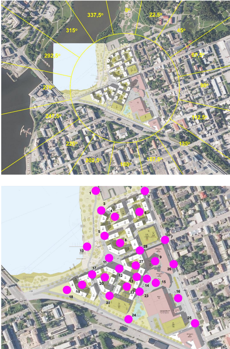
Kuva 2: Tuulensuuntien koordinaatisto ja tuulisuuden numeroarvojen tarkastelupisteet (kuva muokattu Arkkitehtitoimisto Helamaa & Heiskanen Oy ja Maanmittauslaitoksen aineistoista).
